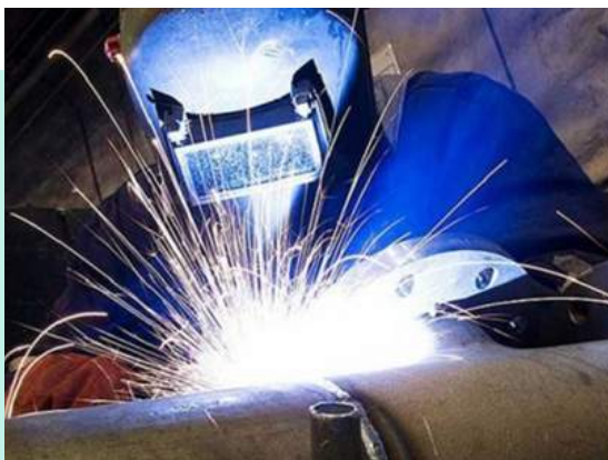
شکل ۲ - جوشکاری با الکترو دستی، از روش های مرسوم جوشکاری ذوبی
