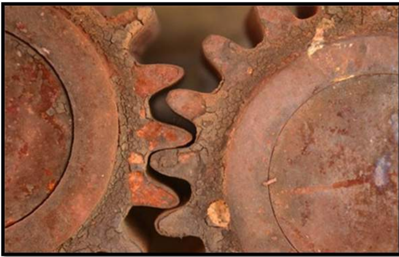
شکل ۱ - نمونه‌ای از تخریب خودبه‌خودی (خوردگی) چرخ‌دنده‌ها
