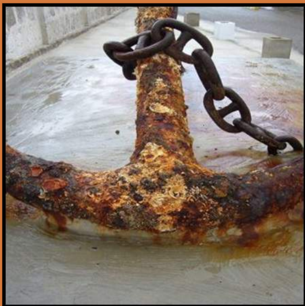
شکل ۲ - نمونه‌ای از خوردگی شدید لنگر کشتی
