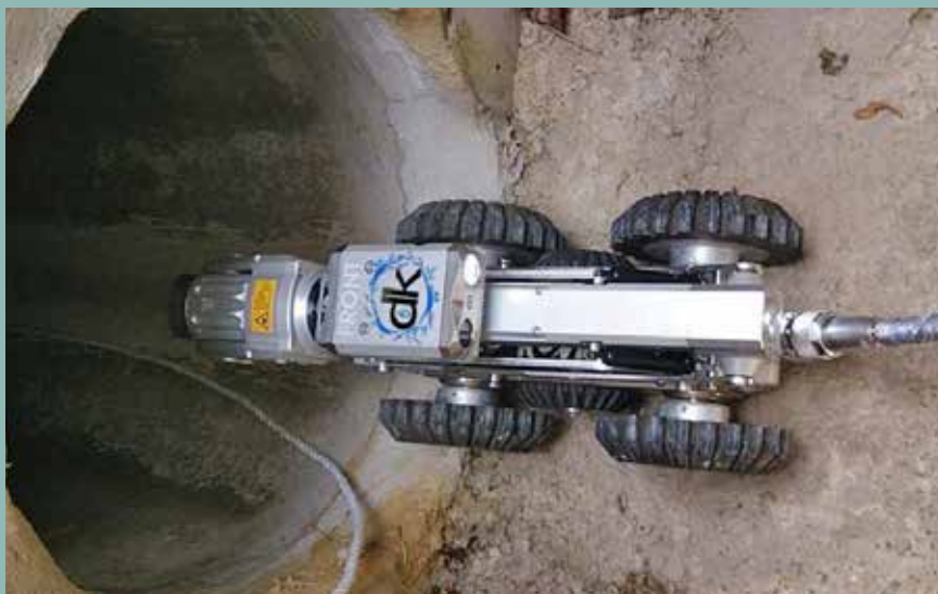
تصویر واقعی از یک سیستم متحرک بازرسی نوری خط لوله [۲]
