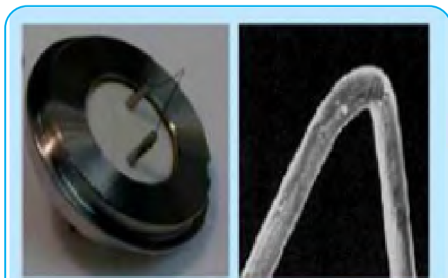
شکل ۴- تفنگ الکترونی با فیلامان تنگستنی
