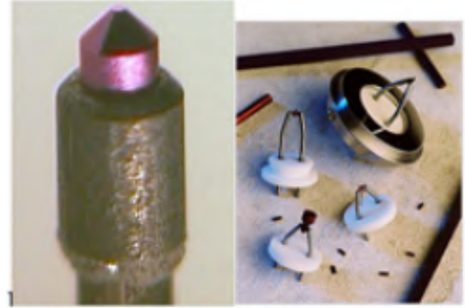
شکل ۵- تفنگ الکترونی با فیلامان لاتانیوم هگزابوراید
