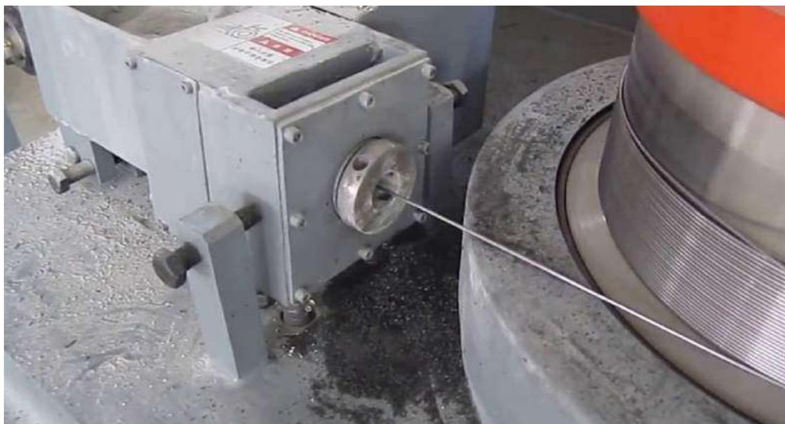
شکل ۷- تغییر شکل فلزات توسط فرایند کشش سیم
