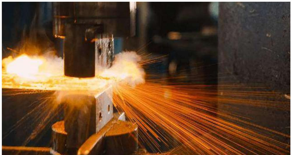
شکل ۶- تغییر شکل فلزات توسط فرایند آهن‌گری
