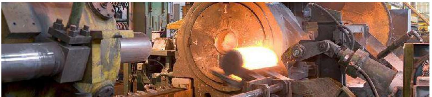
شکل ۲- تغییر شکل فلزات توسط فرایند اکستروژن گرم
