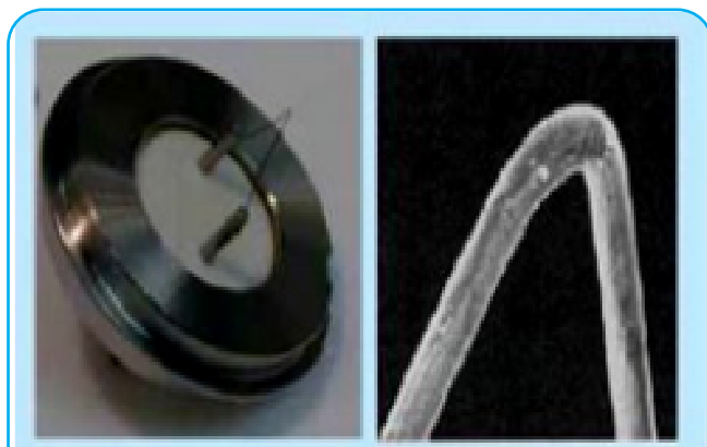
شکل ۴- تفنگ الکترونی با فیلامان تنگستنی
