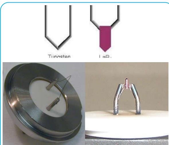
شکل-۳- تصویر شماتیک و واقعی لاتانیوم هگزاپوراید (راست) و تنگستن (چپ) به کار رفته در تفنگ الکترونی [۵]
