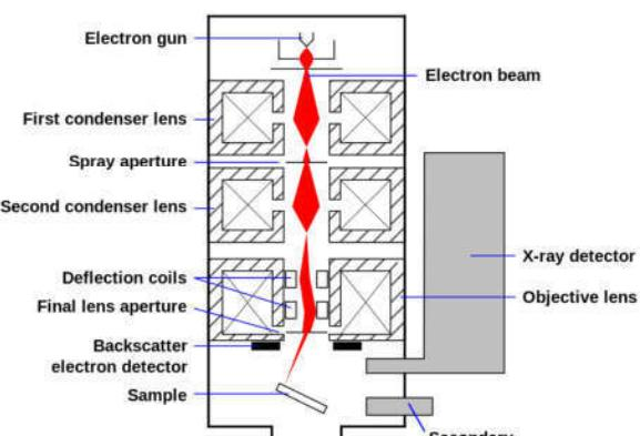
شکل-۴- شماتیکی از بخش‌های مختلف میکروسکوپ الکترونی روبشی [۶]
